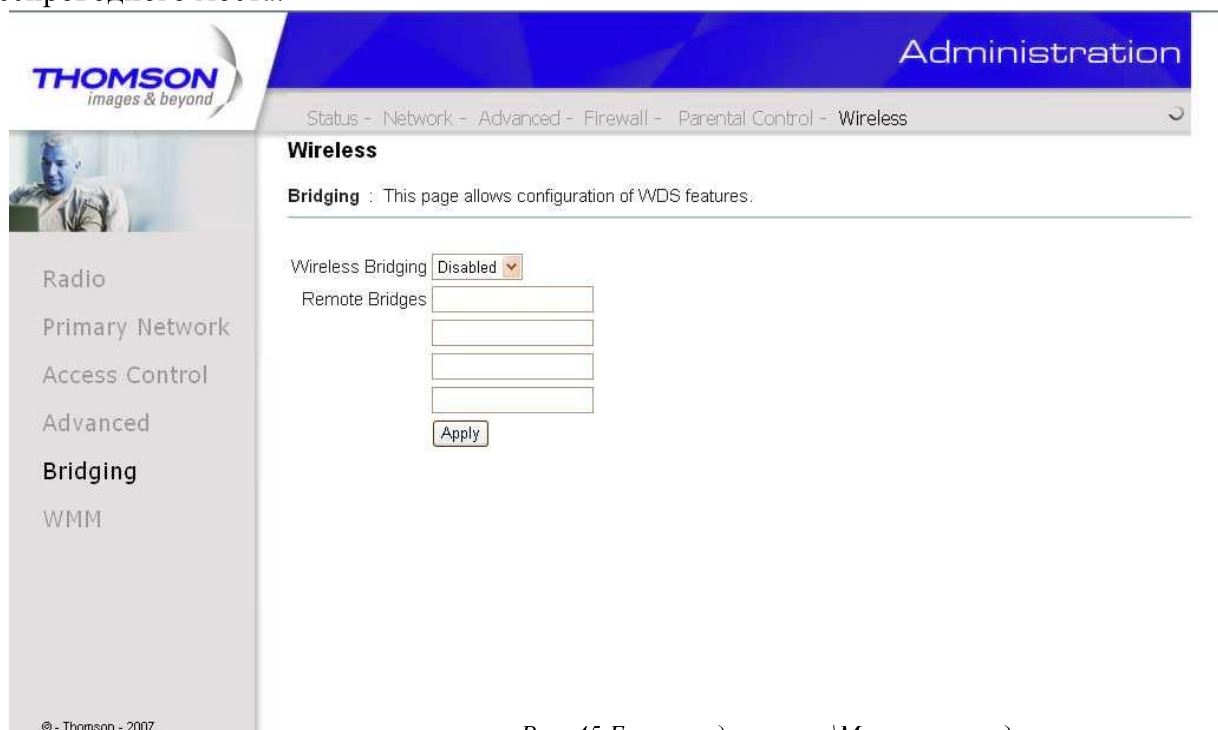
Рис. 45 Беспроводная связь\Мостовое соединение
