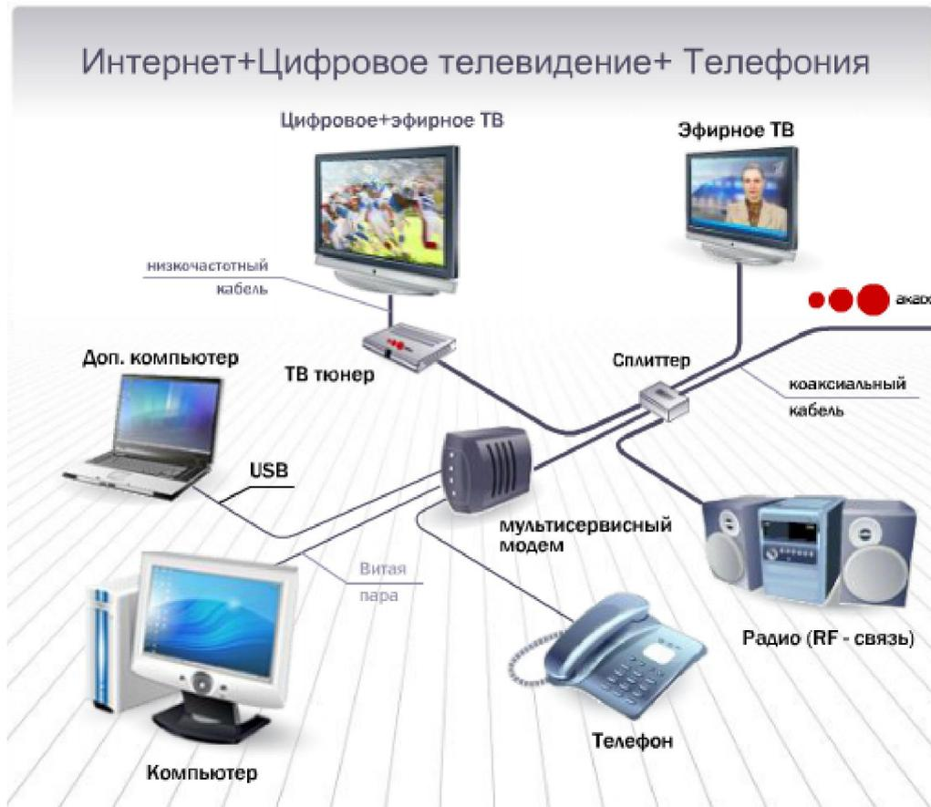
**Рисунок 1. Общая схема подключения мультисервисного кабельного модема.**
