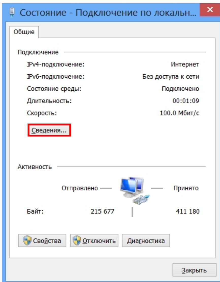
5. В открывшемся окне «Сведения о сетевом подключении» можно уточнить все основные сетевые параметры, такие как mac-адрес (физический адрес), IP-адрес, маску подсети, основной шлюз и DNS-серверы.
