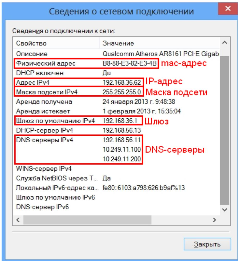
Если в строке IP-адрес стоит адрес вида **169.254.x.x** или **0.0.0.0**, это означает, что при получении сетевых параметров (IP-адрес, маска, шлюз, DNS) возникла ошибка. В данном случае необходимо обратиться в техническую поддержку АКАДО.
