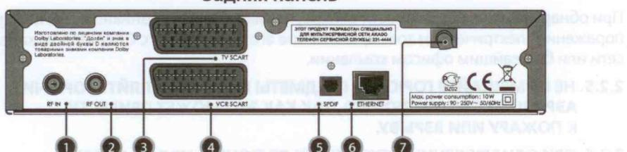
Рис. 2. Задняя панель тюнера
