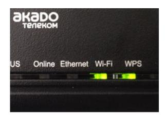
После этого в течение 5 минут абонент может подключить компьютер или иное устройство, поддерживающее технологию WPS к беспроводной сети без введения ключа сети. После установки соединения индикатор «WPS» горит постоянно.
