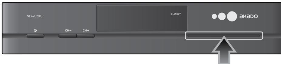
Вставьте карту доступа контактной площадкой вниз в гнездо до упора. При установке карты доступа не прикладывайте чрезмерных усилий. После установки карты может потребоваться некоторое время для её активации.
